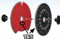
Baut jedes Manöverrad wie gezeigt zusammen. Legt dazu die beiden Seiten mit der Aufschrift „T65“ bzw. die beiden Seiten mit der Aufschrift „TF“ aneinander und befestigt sie mit Verbindungsstücken.
