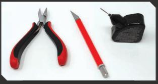
Drei Werkzeuge sind besonders nützlich bei der Arbeit mit Kunststoff-Gussrahmen (von links nach rechts): Ein Seitenschneider, ein Cuttermesser und Kunststoffkleber. Kunststoffkleber kann nur mit Hartplastik verwendet werden, wie er bei diesen Gussrahmen verwendet wird. Sekundenkleber funktioniert bei allen Kunststoffarten, wir raten jedoch davon ab.
