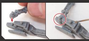
Platziere das hintere Scharnier des Beiwagens über den Stift an der Rückseite des Beiwagenbodens. Tupfe etwas Kleber auf die Oberseite des Beiwagenboden in der Nähe des zweiten Stifts. Achte darauf, dass kein Kleber an das Scharnier kommt, damit der Beiwagen beweglich bleibt.
